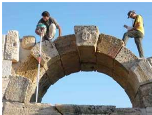
2. Hierapolis di Frigia (Turchia), estate 2008. Misurazioni col GPS in modalità RTK, lungo le mura di epoca bizantina.
